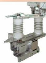
Capacidad de 900 amperes continuos en valores de tensión de hasta 29kV. Interrupción sin arcos externos, lo que los convierte en los más adecuados para: conexión/desconexión de líneas, transformadores y cables.
